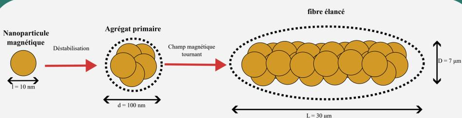
Les nanoparticules d'oxyde de fer  $\gamma-Fe_2O_3$  sont destabilisées grâce à l'ajout de NaCl dont les ions  $Na^+$  vont diminuer les charges de surface des nanoparticules et permettre l'agrégation des nanoparticules en agrégats primaires d'une taille de 100 nm. [1]
