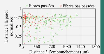
Les grandes fibres ont une probabilité plus élevée de choquer l'embranchement, de plus la présence d'un flux rémanent force les fibres élançées à avoir une trajectoire diagonale diminuant la probabilité de passage d'une fibre élançée située proche de l'embranchement et loin de la paroi.
