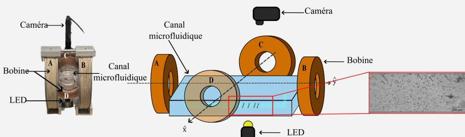
Un gradient de champ magnétique permet de plaquer les fibres contre la paroi souhaitée, mais la vitesse générée par le déplacement n'est pas linéaire avec la fréquence, il y a une compétition entre la taille des fibres et la fréquence qui leur est imposée, une grande fibre roule plus facilement contre la paroi alors qu'une grande fréquence va engendrer une cassure aux extrémités des fibres ce qui va les ralentir. [3]
