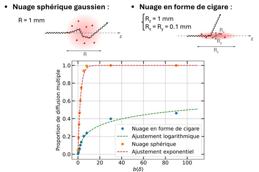
Résultats numériques de la proportion de diffusion multiple en fonction de l'épaisseur optique dans la direction  $z$  pour deux géométries de nuage différentes
